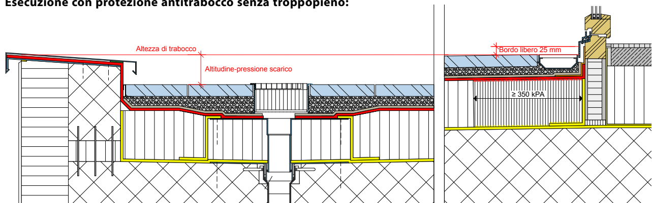
Fig. 6: Superficie calpestabile chiusa in alto
